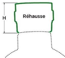
Il est souhaitable que l'installation soit le moins profond possible pour faciliter l'entretien et éviter les surcharges de terre sur la cuve
