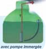
Installation avec pompe immergée
