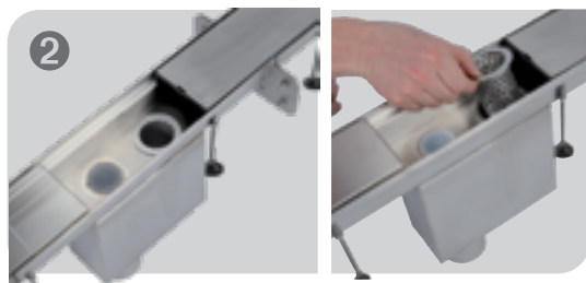
Décalez la grille de caniveau et accédez aisément au panier de récupération des déchets (de série) ainsi qu'au bouchon de dégorgeement.
